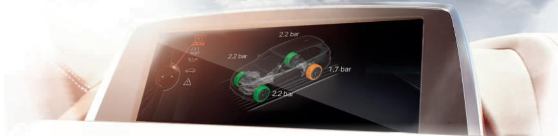
Od marta 2014. godine, svi novi BMW automobili opremljeni su sistemom za kontrolu pritiska pneumatika (RDC). Ovaj sistem znači da uvek možete provjeriti pritisak u pneumaticima.
