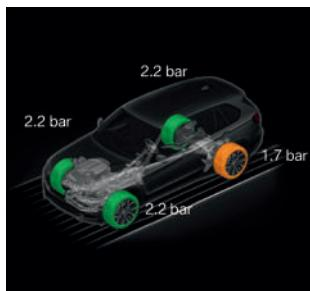
RDC senzor je instaliran u ventil pneumatika sva četiri točka i prati pritisak svakog pojedinačnog pneumatika. Pri kritičnom pritisku (20% ispod definisanog minimalnog pritiska manjeg od 1,7 bara) kontrolni ekran Vas upozorava i omogućava da preduzmete neophodne akcije.
